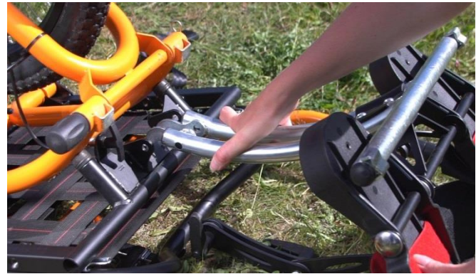
6- Plasser hakene i spaltene. Klem rørene litt sammen så de passer inn
