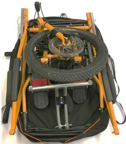
3- Plasser fotbrettet på hodestøtta
