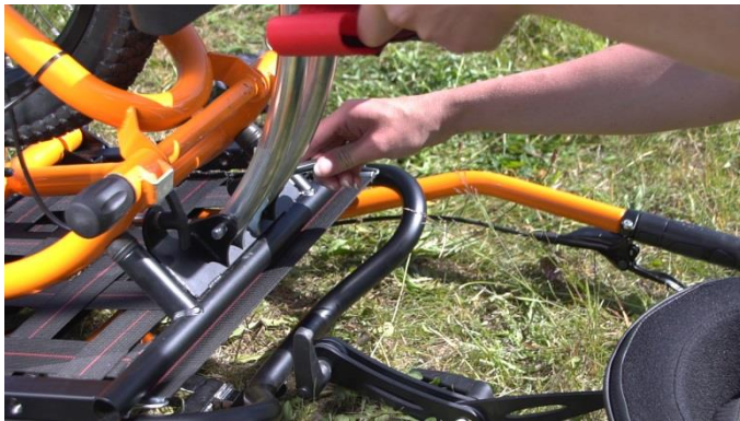
7- putt låsepinnen på plass. Husk låse splinten.
