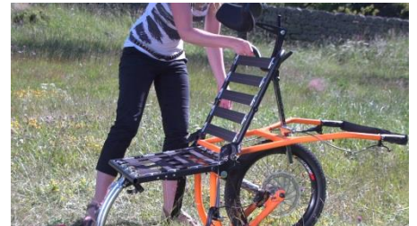
16- Fold ut trekkarmene og fest med låsebolt
