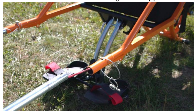
16- Fold ut trekkarmene og fest med låsebolt
