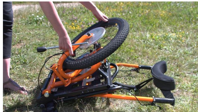
2- Ta ut låsepinnen og splinten og roter hjulet på plass
