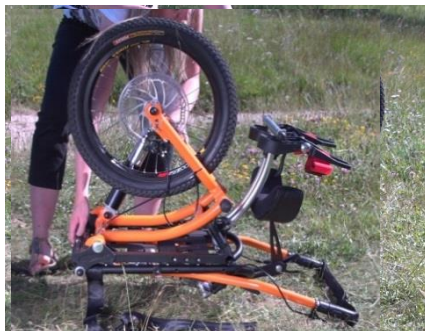
7- putt låsepinnen på plass. Husk låse splinten.
